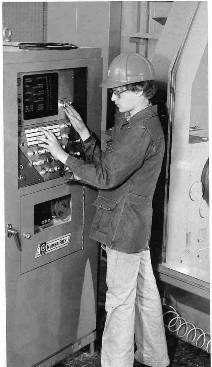
En su planta de Querétaro, Industria del Hierro, cuenta con máquinas-herramientas equipadas con los sistemas más modernos de control numérico a base de microprocesadores.
